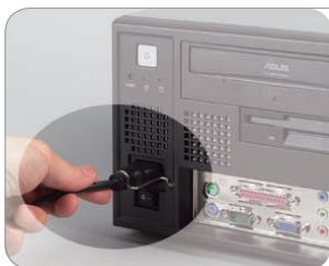
插頭環鎖可將電源線牢牢固定
