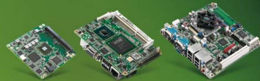
研華提供一系列使用Intel® Atom™處理器之低功耗嵌入式平台，此一平台使用Intel 32奈米製造流程，且DDR3的時脈被提升達到1066MHz以加強效能。這些低功耗平台提供了節能及環境保護的解決方案，更可作為手持式裝置、POS、Kiosks、醫療及工廠自動化等應用的最佳選擇。
