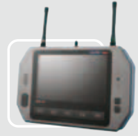
TREK-753 X86架構長途貨運車隊管理專用車載電腦
