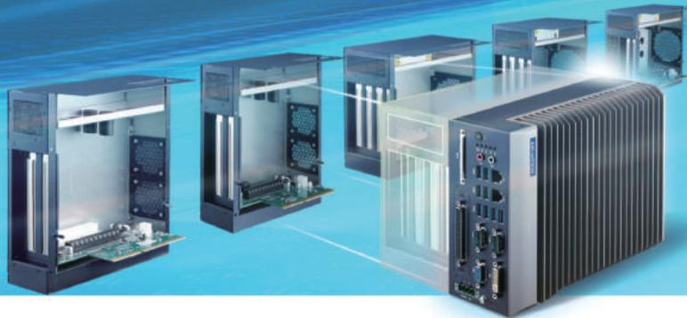
對於這兩種模式，MIC-7500從設計面滿足市場，在操作時脈部分，MIC-7500採用了Intel的Core i架構，由於Core i向以高效能為設計重點，因此可因應相關需求，此外研華也正開發多核心產品，與Core i最多只到4核心不同，多核心的核心數最高可到12核，這兩類設計分別滿足了不同機器視覺系統的需求。
