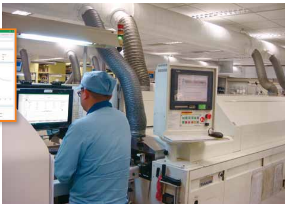
研華林口製造中心已實際導入交大「溫度監控與虛擬量測分析」於SMT生產，有效紀錄每片板子即時的溫度變化，進而精準掌控生產品質。
